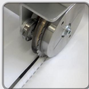
Der Längsschneider sorgt für einen sauberen Schnitt und eine schöne Nahtimitation, bei vollsynthetischem Material von 150 bis 750 Gramm pro Quadratmeter.
