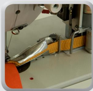
Apport du ruban motorisé avec contrôle de tension.
