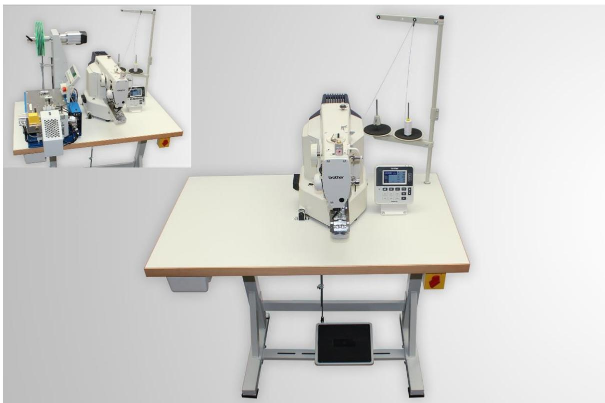
Dieser Riegelautomat kann direkt neben die Schneidemaschine gestellt werden, damit ein kontinuierlicher und reibungsloser Produktionsablauf gewährleistet ist.
